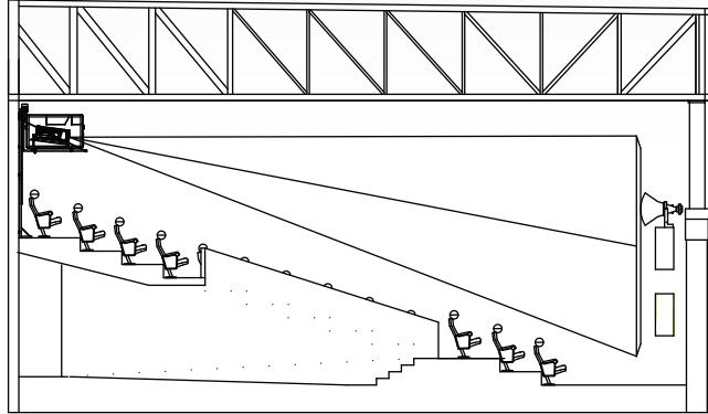
**El elevador de pared P-WALLIFTBOX permite descender nuestra solución para cine sin cabina, el P-SBOX14, desde su ubicación de proyección en la parte alta de la pared de fondo de sala hasta la posición de mantenimiento.**
